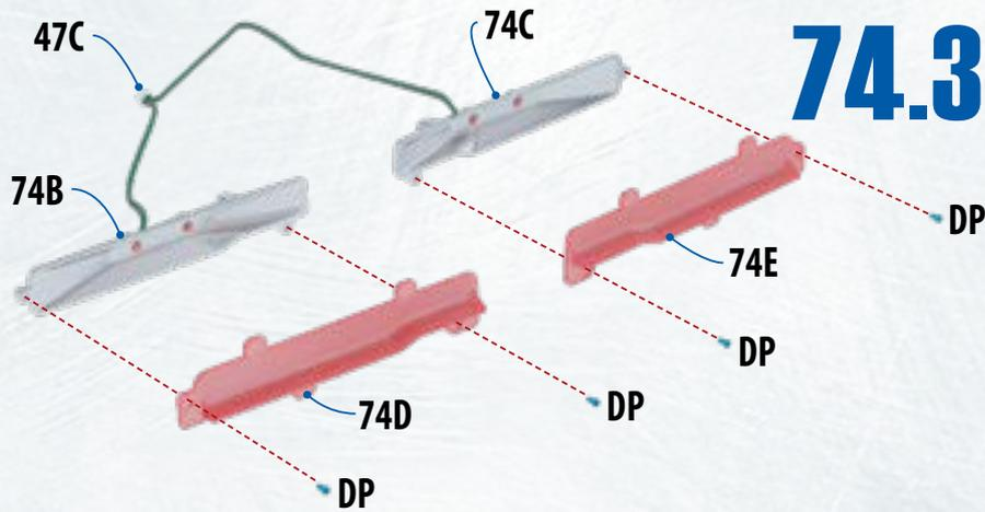
**74.3** **Установите** стекло 74D на деталь 74В, а стекло 74Е — на деталь 74С. Закрепите каждое из стекол двумя винтами DP. ◀
