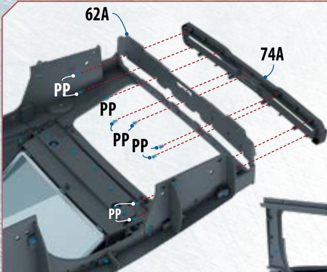
**74.5** Возьмите собранный кузов и осторожно переверните его, поставив на крышу. Установите заднюю панель корпуса 74А на заднюю часть корпуса 62А и зафиксируйте ее девятью винтами PP. ◀
