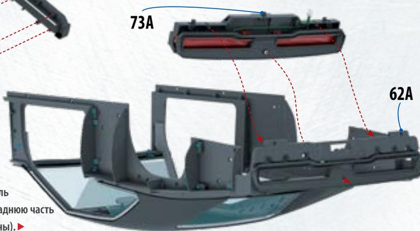
**74.6** Установите заднюю панель багажника 73А с фонарями на заднюю часть кузова 62А (с внутренней стороны). ▶
