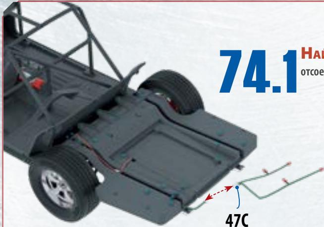
**74.1** **Найдите** на модели провод 47С и осторожно отсоедините часть со светодиодами. ◀
