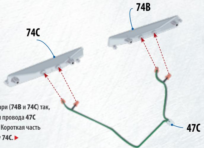
**74.2** **Расположите** левый и правый задние фонари (74В и 74С) так, как показано на фотографии. Вставьте светодиоды провода 47С в соответствующие отверстия указанных деталей. Короткая часть провода 47С соответствует левому фонарю 74В, а длинная — правому 74С. ▶
