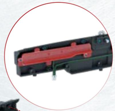
**74.4** **Возьмите** заднюю панель багажника 73А и установите на нее корпуса задних фонарей 74В и 74С. Зафиксируйте собранную конструкцию четырьмя винтами CP с обратной стороны панели. Проложите провод так, как показано на фотографии. ▶
